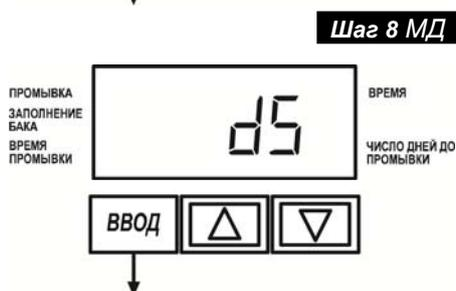
**Шаг 8МД – Регенерация в Четверг** – Для того, чтобы проводить регенерацию в четверг нажимайте кнопку «ВНИЗ» или «ВВЕРХ» до тех пор, пока рядом с надписью «ПРОМЫВКА» не появится стрелка. Если рядом с надписью «ПРОМЫВКА» стрелки не будет, то регенерация в этот день не проводится.
