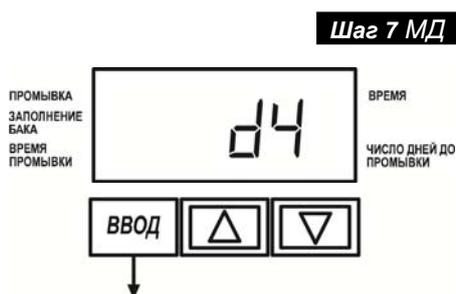
**Шаг 7МД – Регенерация в Среду** – Для того, чтобы проводить регенерацию в среду нажимайте кнопку «ВНИЗ» или «ВВЕРХ» до тех пор, пока рядом с надписью «ПРОМЫВКА» не появится стрелка. Если рядом с надписью «ПРОМЫВКА» стрелки не будет, то регенерация в этот день не проводится.
