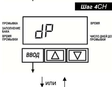
**Шаг 4СН** – Если установлен датчик перепада давления, и он активирован, то далее выбирается способ начала регенерации:
